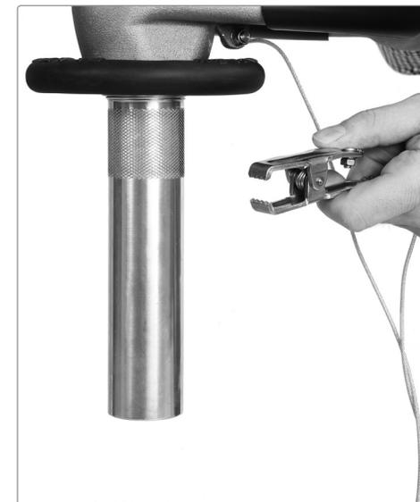
Einsatz der **Erdungskabelgarnitur EKG**: Anbringung an der Befestigungsöse unterhalb des Zapfventilgehäuses. Das Aufwickeln des Kabels erfolgt um den Protektorring.
